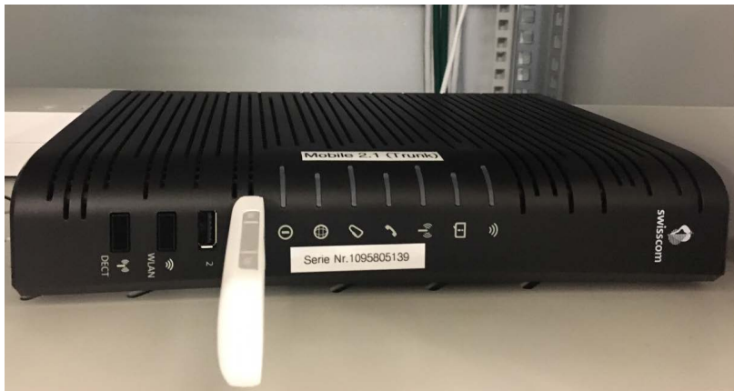
Abb 8: Modem / Router SBCON Centro Business 2.0 Swiss mit USB-Stick für 4G LTE
