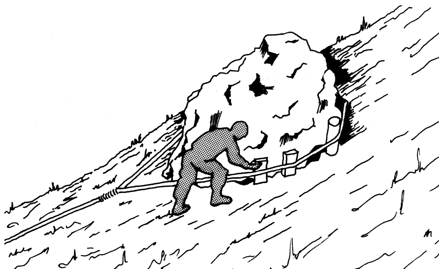
Bild 5.35 Verankerung an Felsblöcken
