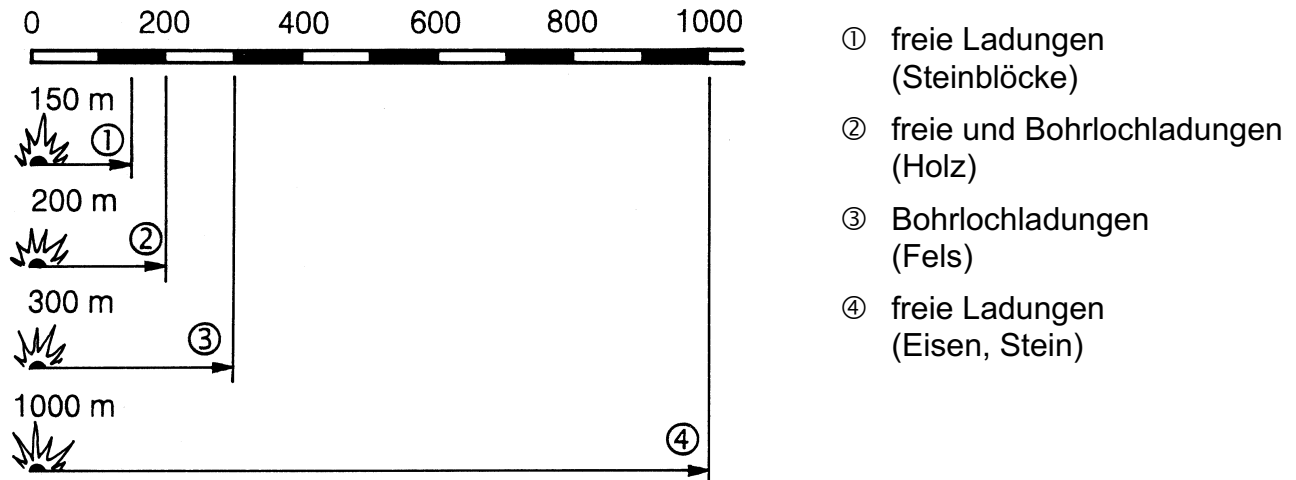
Bild 5.39 Wurfweiten
