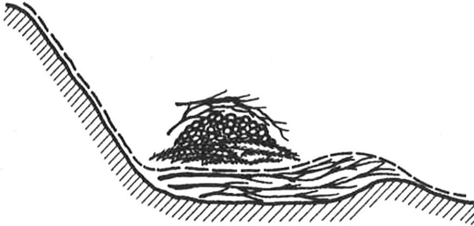
Abb. 42 Kies, Überdeckung (Bauvorgang 3, Faschinenwalze)
