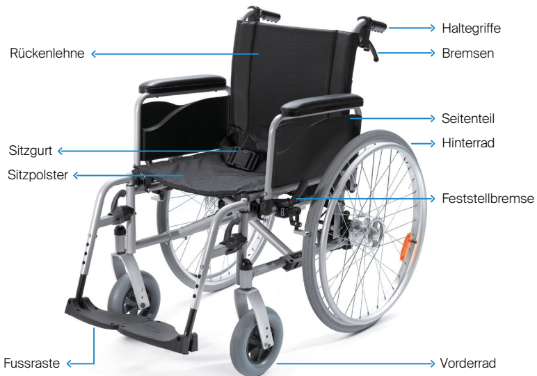
Abb. 1: Ein Rollstuhl und seine Einzelteile.
