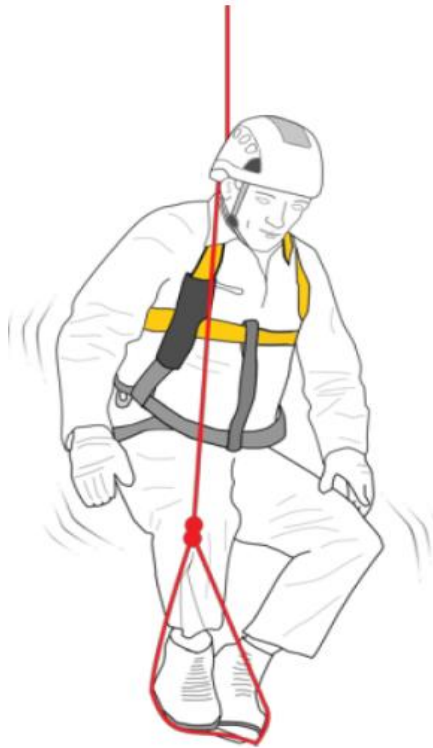
Abb. 19: Entlasten der Beine mit einer Trittschlinge (Petzl)
