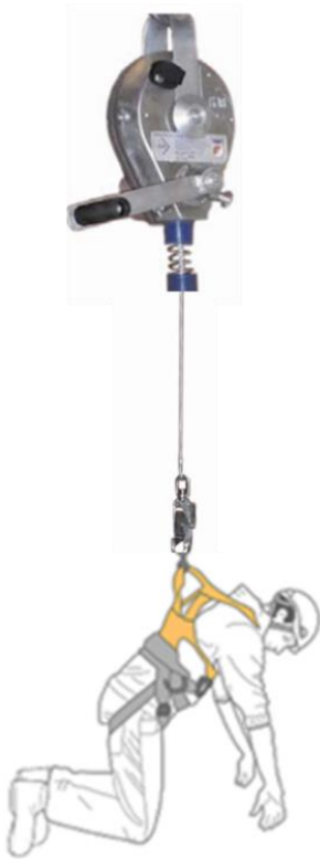
Abb. 28: Rettung mit einem Höhensicherungsgerät (BABS)
