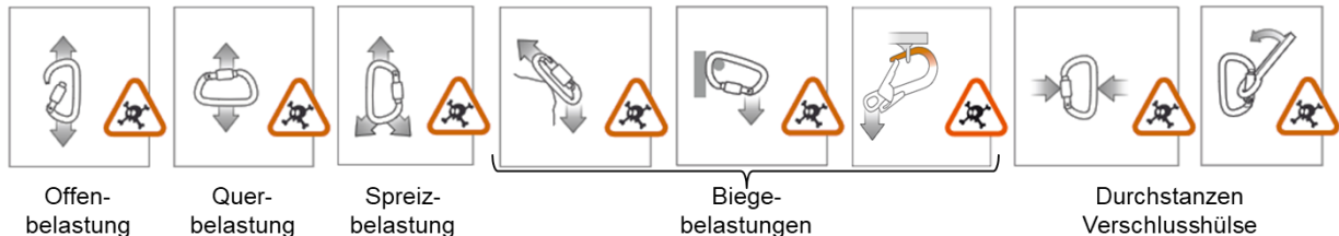
Abb. 10: Fehlbelastungen bei Karabinerhaken (Petzl)
